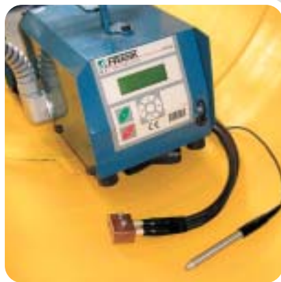
Elektromuffenschweißgerät für PKS-Rohre
