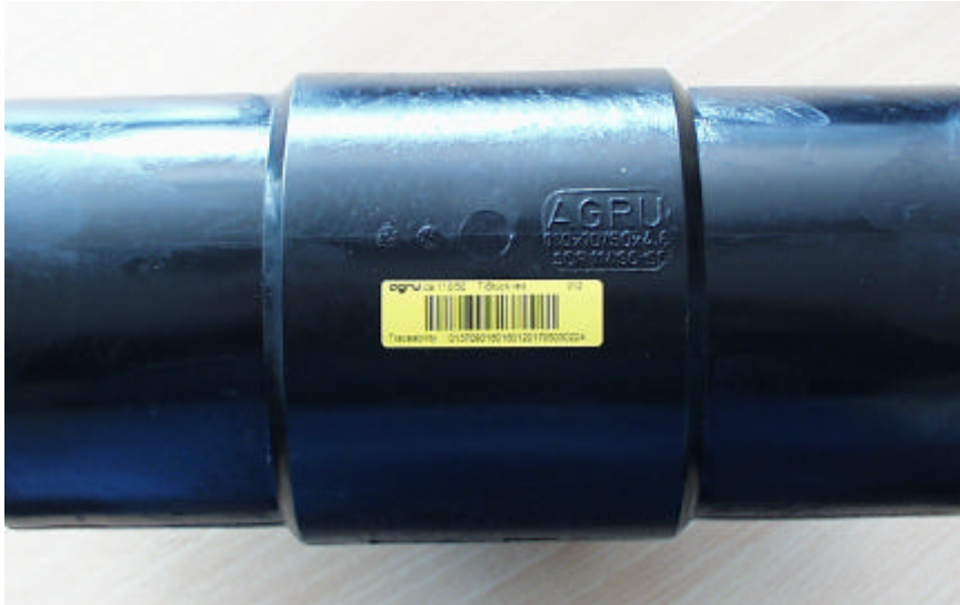
Bild 4: Formteil für HS-Schweißung mit Rückverfolgbarkeitscode
