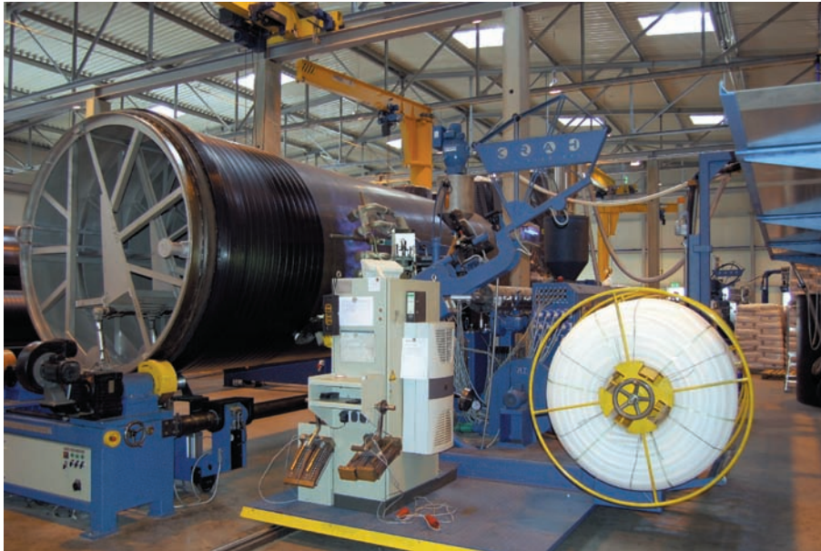
Bild 3: Herstellung der Wickelrohre bei der Frank & Krah GmbH nach PAF C 1065 DIN 16961
