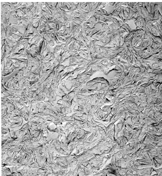
Bild 9: Kristallitstruktur PE-Xb-Rohr (analog PE-Xc) ca. 7500fache Vergrößerung
