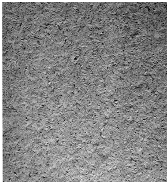
Bild 10: Kristallitstruktur PE-Xa-Rohr ca. 7500fache Vergrößerung
