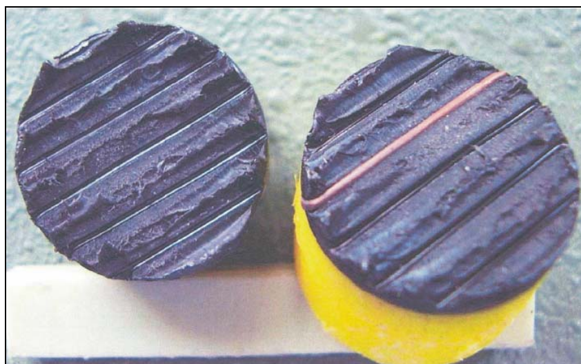
Bild 29: Typisches Bruchbild einer fachgerecht hergestellten Heizwendelschweißung (Bruch in der Heizwendelebene)
