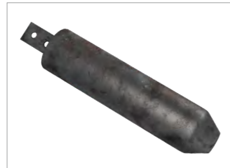
Peso zavorra: peso in acciaio per ridurre la resistenza di inserimento delle sonde geotermiche
