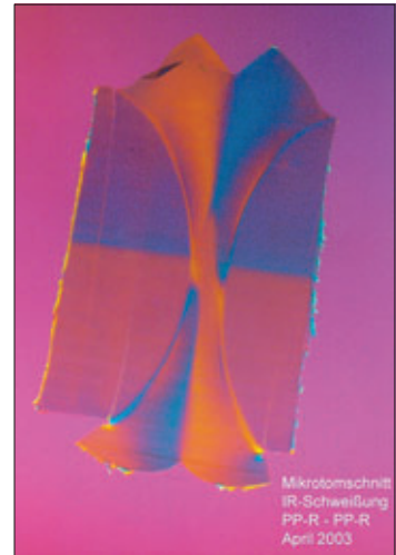
Bild 16: Mikrotomschnitt an einer gebrochenen IR-Schweißprobe aus PP-R
