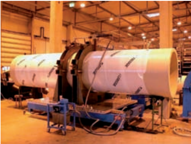
Bild 4: Heizelementstumpfschweißen von zwei PP Wickelrohren nach DVS 2207-11
