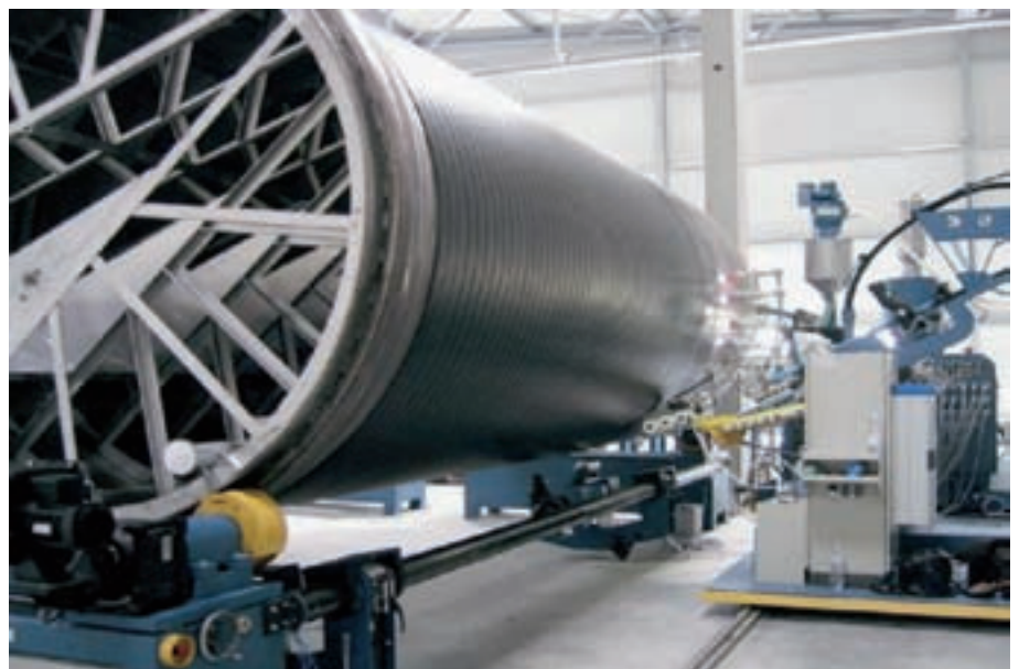
Bild 1: Herstellung der Wickelrohre bei der Frank&Krah Wickelrohr GmbH nach DIN 16961
