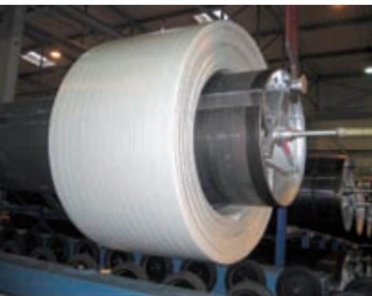
Bild 3: Hohlstab DN 1200 mit einer Wanddicke von 400 mm
