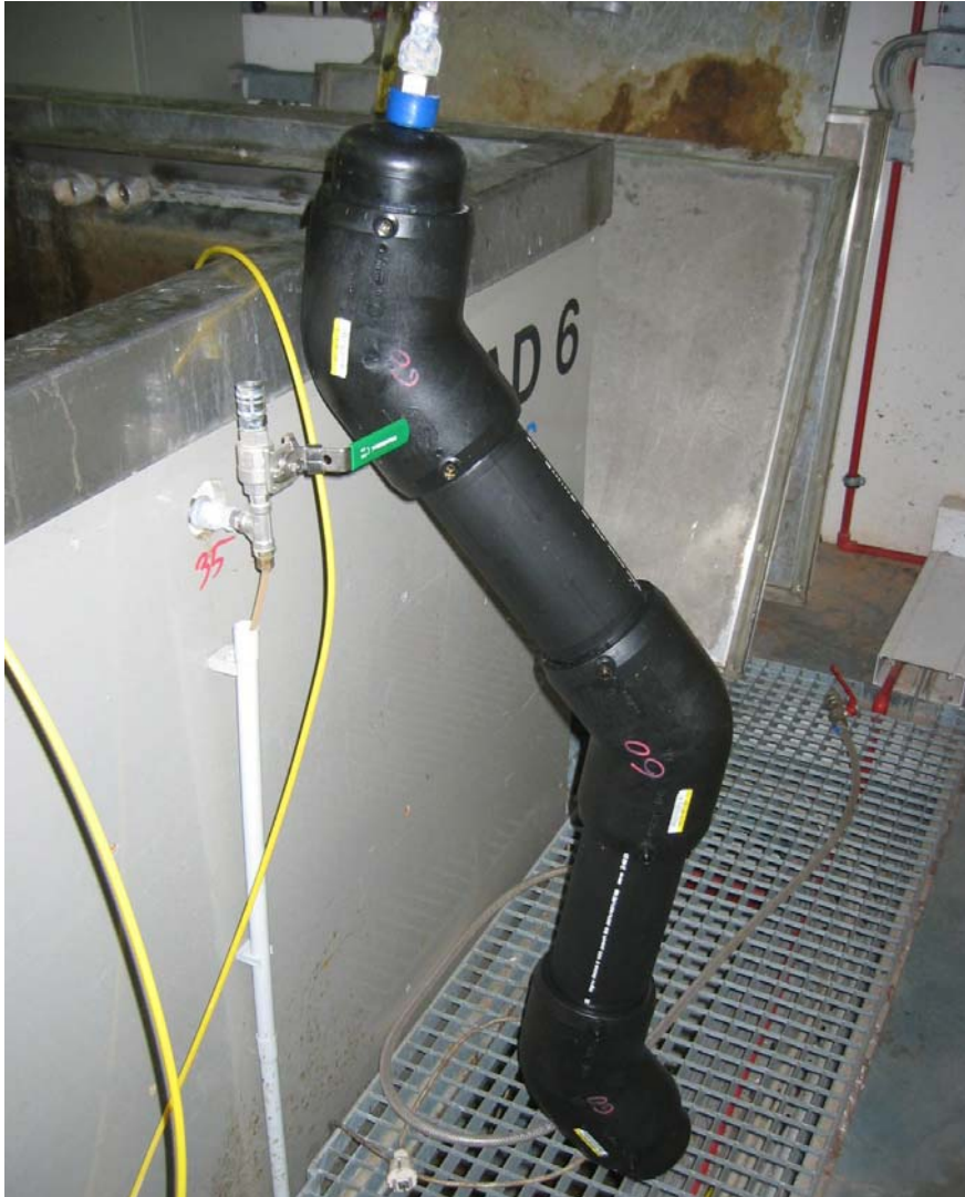
Bild 4: Innen(Berst-)druckprüfung an einem Prüfbaum gemäß FM-Standard 1610
