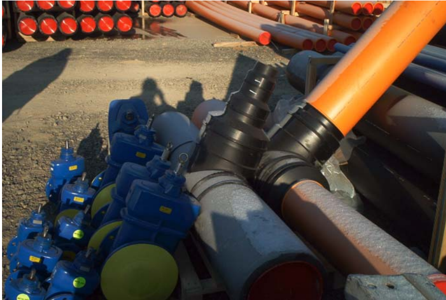
Bild 1: Vorkonfektionierte Abzweige für Gas- und Löschwasserleitung
