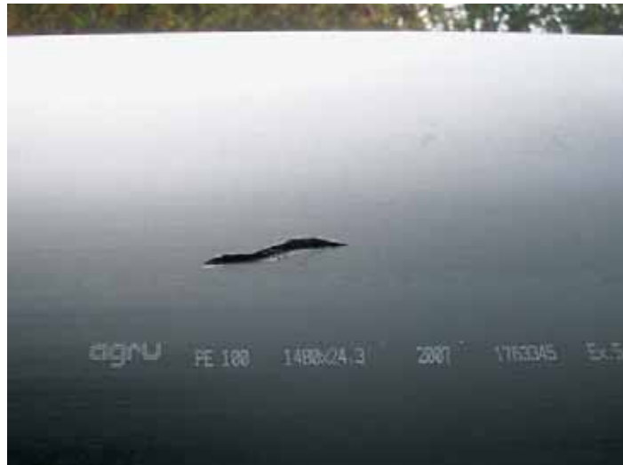
Bild 16: Oberflächenfehler verursacht durch Baustellenhandling
