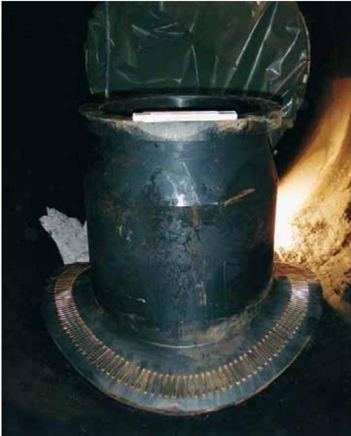
Bild 8: Sattelstützen DN 500 aus PE 100
