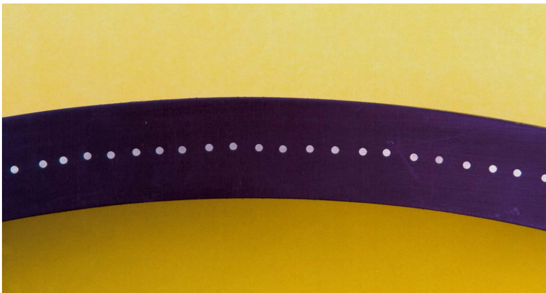
Bild 6: PKS-Elektroschweißmuffe (nach der Schweißung) im Schnitt
