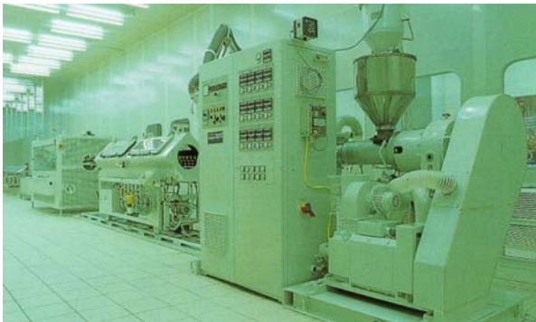
Abb. 7: Rohrextrusion im Reinraum
