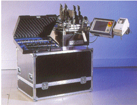
Abb. 12 a, b: Vollautomatische IR Schweißmaschine Typ Agru SP 110 mit automatischer Parameteraufzeichnung
