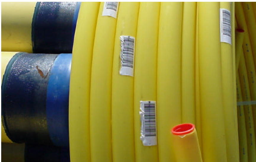
Bild 9: Ringbund mit beschädigten Etiketten
