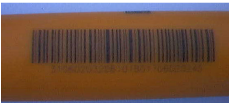
Bild 5: Mit Laser am Rohr aufgebracht Barcode
