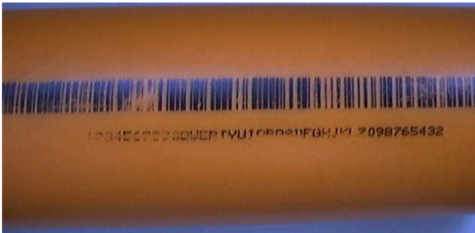
Bild 6: Mit Tintenstrahldrucker am Rohr aufgebracht Barcode
