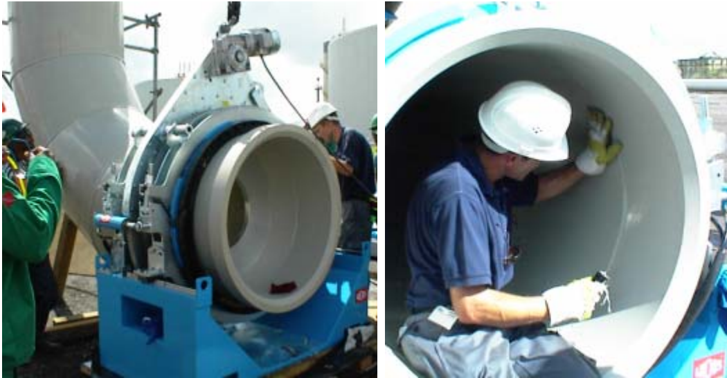
Abbildung 13: Vorkonfektionierung von Sonderbauteilen in Polypropylen
