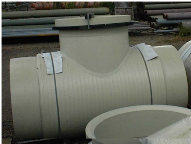
Abbildung 8: Reduziertes T-Stück aus Polypropylen d 1050/ 900mm in SDR 33
