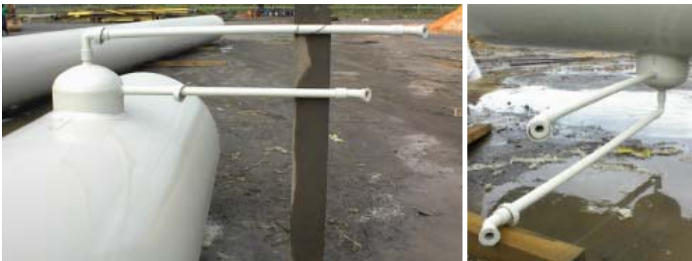
Abbildung 10: Kondensattöpfe aus gespritzten Formteilen (PP-R)
