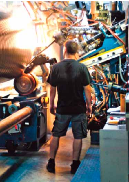
Herstellung der Wickelrohre bei der Frank & Krah GmbH nach DIN 16961
