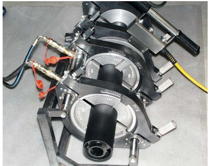
Bild 6: Simultanschweißung Fig. 6: Simultaneous welding
