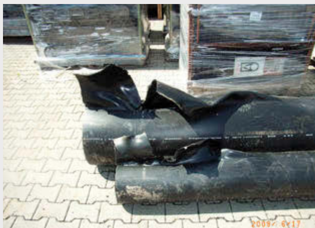
Bild 1: Duktile Brüche verursacht durch zu hohe Prüftemperaturen während der Innendruckprüfung ( d_s 280 mm und 450 mm SDR 17 PE-Rohre)
