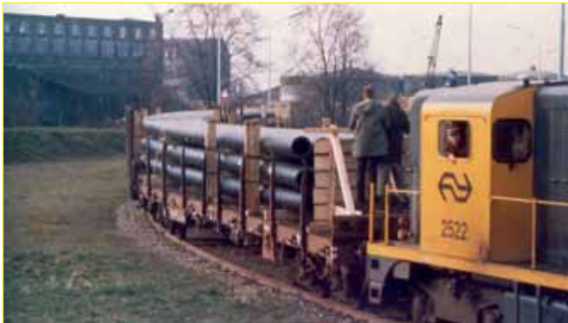
Bild 13: Die Elastizität der Rohre lässt auch im Kurvenbereich den Transport von großen Rohrlängen zu
