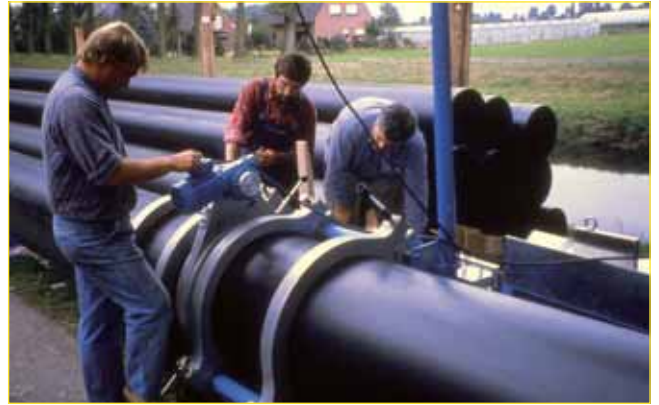
Bild 14: Stumpfschweißmaschine mit CNC-Steuerung und automatischer Protokollierung der Schweißparameter
