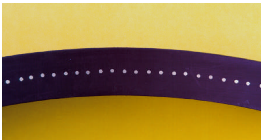
Bild 6: PKS-Elektroschweißmuffe (nach der Schweißung) im Schnitt
