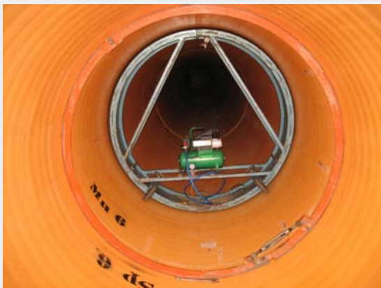
Abb. 8: Pneumatisches Muffendruckprüfgerät DN 2000
