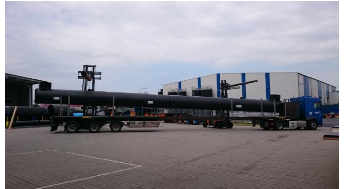
Bild 4: Staukanal DN 1200, 24 Meter Baulänge bei der Verladung
