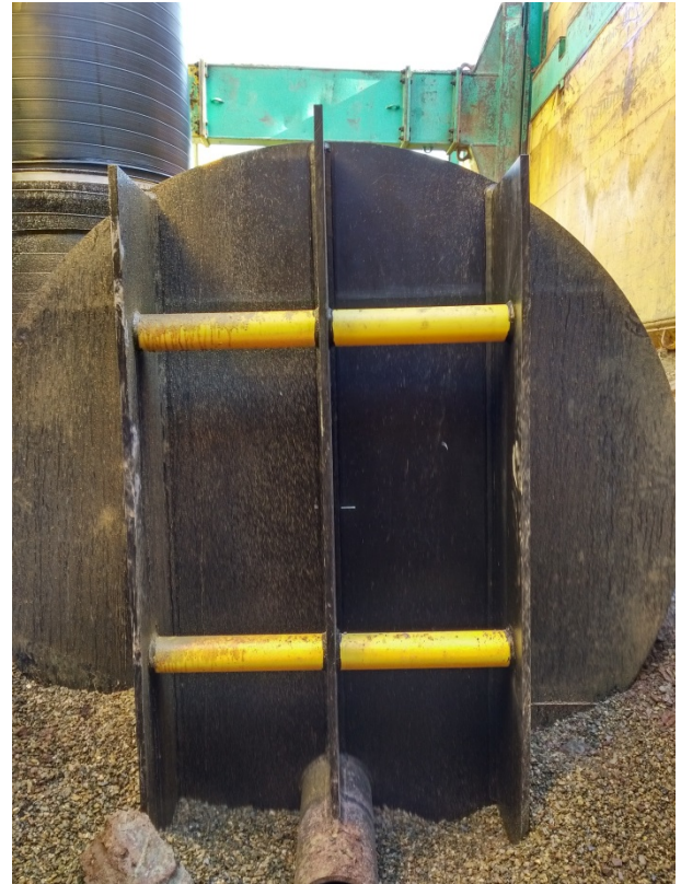
Endplatte mit Streben, Zulaufstutzen d250, Tangentialschacht DN 1000
