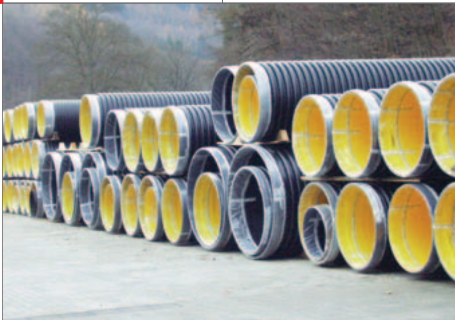
Bild 1: Lagernde PKS-Rohre mit inspektionsfreundlicher heller Rohrinneenseite
