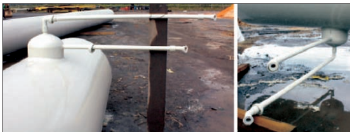
Bild 5: Kondensattöpfe aus gespritzten Formteilen (PP-R)
