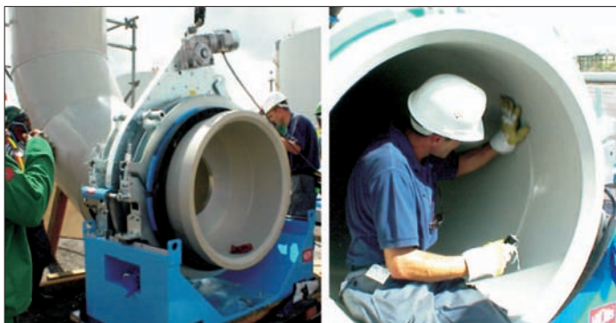
Bild 6: Vorkonfektionierung von Sonderbauteilen in Polypropylen
